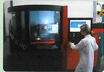
Laserschneiden mit der EMCO Anlage
